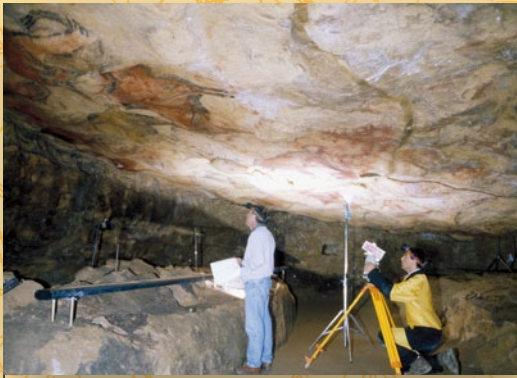
Medición de puntos de apoyo en la sala de polícromos.
