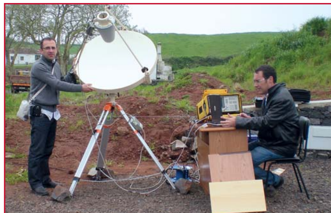
Sistema de medida de interferencias durante las medidas en Fontes do Jordão a 44 grados de elevación
