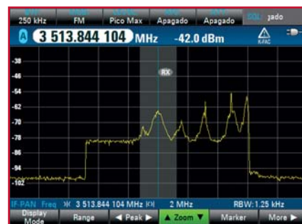
Ejemplo de señal de interferencia captada durante las mediciones
