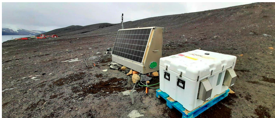
Estación sísmica de banda ancha y pila de combustible (metanol). Al fondo, la base española Gabriel de Castilla, isla Decepción (Antártida).
