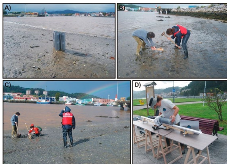
Figura 1. Proceso de muestreo en la Ría de Avilés: A) Emplazamiento de los 4 tubos de PVC vacíos para la obtención de 4 réplicas; B) Inserción de los tubos en el sedimento; C) Extracción de los tubos con los testigos; D) Medida in situ de la susceptibilidad magnética de los testigos enteros.
