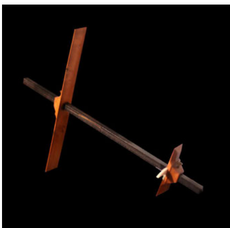
Determinación de la altura de la Estrella Polar por medio de la vara de Jacob.
