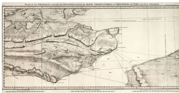
Triangulación geodésica que unió los observatorios de Greenwich y de París, y permitió determinar la diferencia de longitudes geográficas entre ambos.
