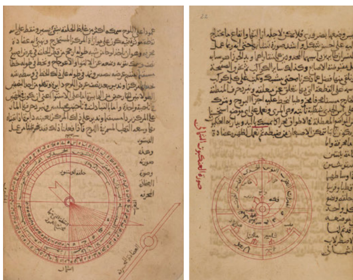
Dos ilustraciones en el tratado del astrolabio de al Biruni. En la de la izquierda figura la madre y la alidada, mientras que la derecha presenta la araña. British Library.
