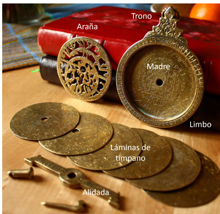
Componentes de un Astrolabio del siglo XVIII.
