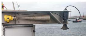
VegaPuls WL62 y WL61 sensores radar
